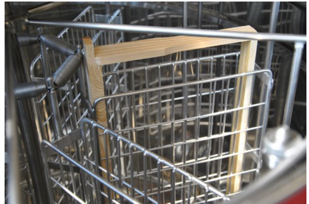
Рис.1 правильное расположение рамок в медогонке
