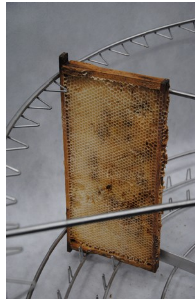
Рис.2 Правильное расположение рамки в Радиальной корзине
